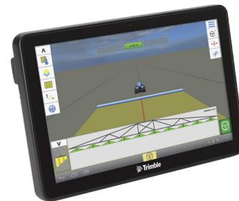
**Information :** En cas d'interruption du signal RTK, la technologie Trimble xFill permet de maintenir le fonctionnement du système de guidage jusqu'à 20 minutes. Le signal xFill se met automatique en marche lors
